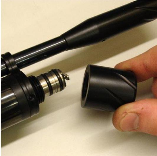
Sobald der Anschluss freiliegt, kann der Adapter an diesen angebracht werden. Den Adapter vollständig aufdrücken, dass die O-Ringe komplett bedeckt sind.
