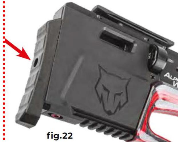
Die Schaftkappe kann nach Bedarf abgesenkt und angehoben werden, indem die 3-mm-Schraube in der Mitte gelöst und wieder angezogen wird, wenn sich die Schaftkappe in der gewünschten Position befindet (fig.22).
