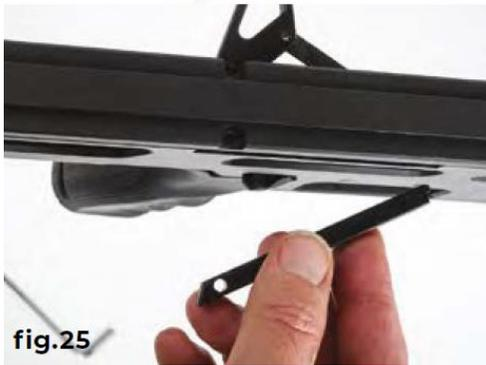
Schwenken Sie den Seitenhebel nach vorne und verwenden Sie in der eben entstandenen Öffnung hinten denselben Innensechskantschlüssel, um die Abdeckplatte aus dem hinteren Teil des Systems zu schieben (fig.25).
