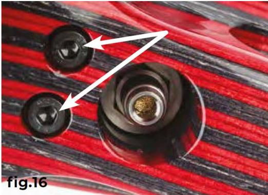
Die zwei kurzen Schrauben vor dem Abzug entfernen (fig.16)
