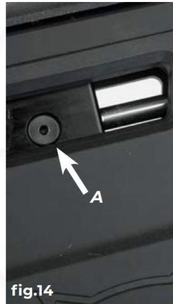
Um den Lauf zu entfernen, lösen Sie die 3-mm-Schraube 'A' und schieben Sie den Lauf ohne Drehung vorsichtig nach vorne (fig.13). Der Wiedereinbau erfolgt in umgekehrter Reihenfolge. Achten Sie darauf, dass die drei elektrischen Stifte mittig mit dem Lauf und dem System ausgerichtet sind.
