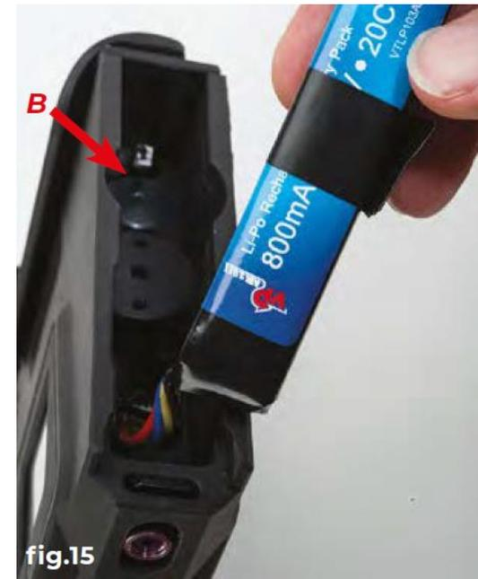
Entfernen Sie die Schaftkappe und kippen Sie die Batterie nach vorne, um an den 3mm Verschlussbolzen zu gelangen (fig. 15). Lösen Sie die Schraube und entfernen Sie Bolzen „B“ damit Sie das Verschlussbolzen-System über die Rückseite des Blocks entfernen können. Der Wiedereinbau erfolgt in umgekehrter Reihenfolge.
