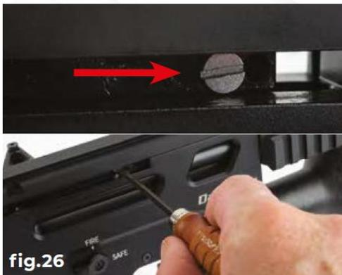
Entfernen Sie mit einem Schraubendreher die silberne Schlitzschraube auf der Seite der Abdeckplatte (fig.26).
