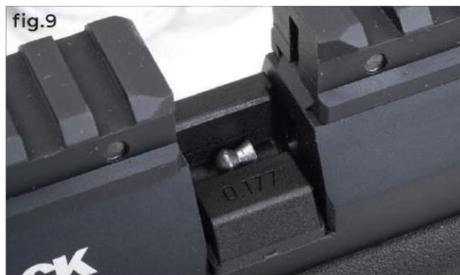
Vergewissern Sie sich, dass das Diabolo nicht verformt ist, und legen Sie es mit der Nase voran ein. Drücken Sie den Seitenhebel nach vorne, um das Diabolo in den Verschluss zu schieben. **DAS GEWEHR IST NUN GESPANNT UND GELADEN** Drücken Sie die Sicherung nach links (entsicherte Position) und betätigen Sie den Abzug, um das Gewehr abzufeuern
